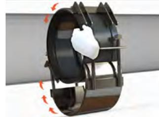
6. Plaquez le joint autour de la canalisation et placez l'extrémité du joint entre la demi-coque supérieure et la plaque de guidage. Pressez fortement le joint contre son extrémité.
