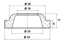
Joint type B NBR standard Ref. 9830984 ou Néoprène Ref. 9830970
