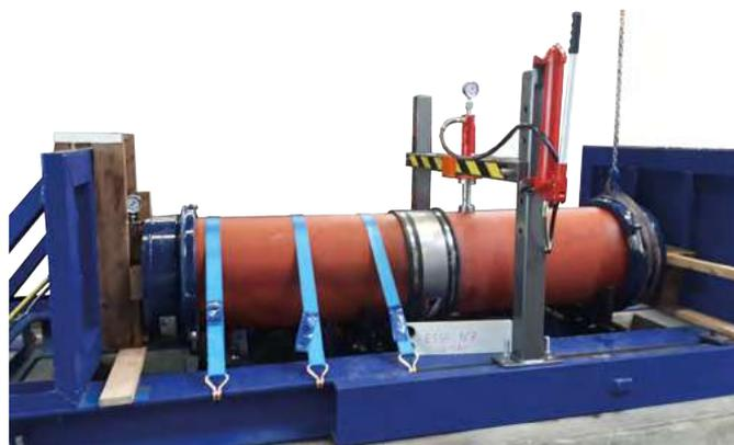
Essais de résistance au cisaillement d'un raccord FLEX-SEAL Plus® SC445. Le même type de test est appliqué à tous les raccords de la gamme FLEX-SEAL Plus®.
